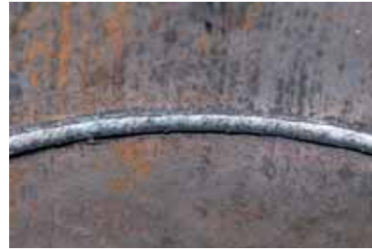
Nahtwurzel am Rohr TIP TIG-geschweißt Werkstoff P235GH, D = 159 mm, t = 12 mm
