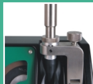
Durch eine seitliche Bewegung kann die Diamantscheibe 3-fach ausgenutzt werden.
