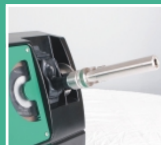
Der Spitz der Wolframelektrode in der 90 Position abflachen.
